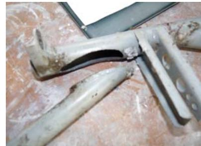
**Hersteller:** Der Hersteller schreibt eine 100 Stundenkontrolle der Steuerknüppelanlage vor.
