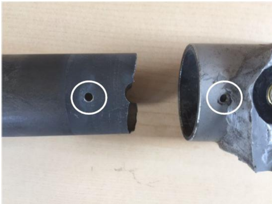
Abbildung 2: Gerissene A-Säule vom äußeren Hülsenteil (rechts im Bild) entfernt. Eingekreiste Löcher zeigen die Position des Niets, der die Teile in axialer Position gehalten hat.
