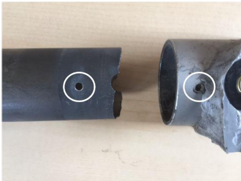
Abbildung 2: Gerissene A-Säule vom äußeren Hülseenteil (rechts im Bild) entfernt. Eingekreiste Löcher zeigen die Position des Niets, der die Teile in axialer Position gehalten hat.
